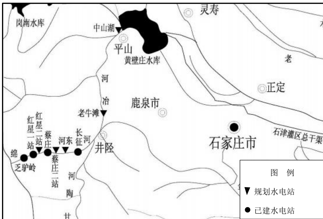
图 2.9-3 绵河、冶河梯级开发简图
